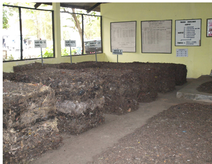
Gambar 7 - Pengomposan Sistem Open Windrow
