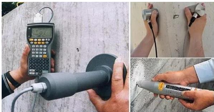
Gambar B.1.9. Pengukuran/pengujian kekuatan beton
