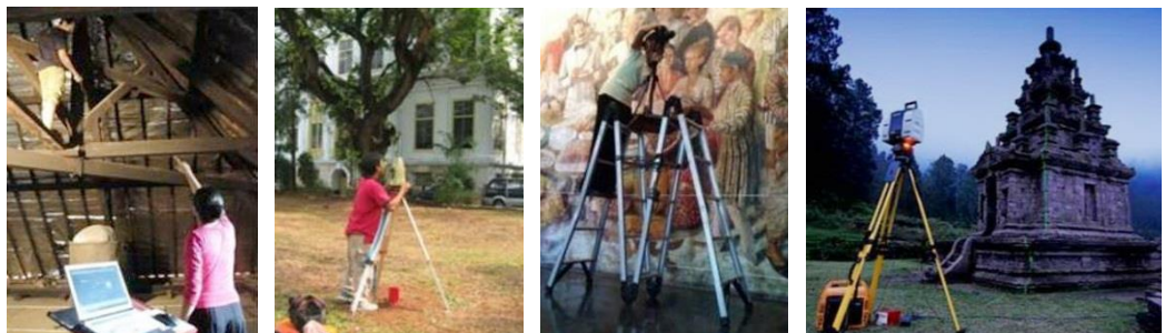
Gambar B.1.14. Teknik pengukuran – dengan cara manual, menggunakan alat teodolit, teknik fotogrametri, serta 3D laser scanner Sumber: Nadia Purwestri (PDA), Metode Pelestarian Bangunan Warisan Budaya Berkelanjutan
